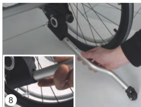
**SWINGBO-VTi** Está equipada con dos soportes antivuelco. La imagen (9) muestra la posición "activa".
