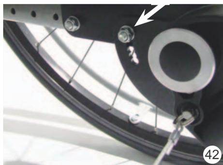
• El ángulo del antivuelco se puede ajustar aflojando el tornillo marcado (42).
