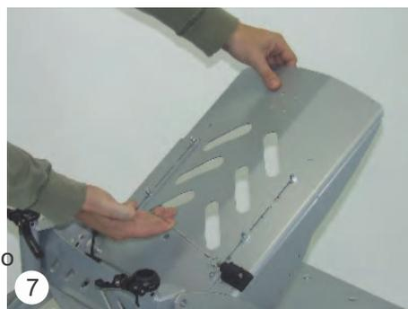
El antivuelco está pre montado (8). Los tubos antivuelco se insertan en su soporte. Pulse el botón a presión y elija la posición de longitud deseada (por favor vea la imagen).
