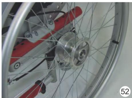
Además de los frenos y los frenos integrados en el guardabarros SWINGBO-VTi puede pedirse con frenos de tambor. Los frenos de tambor se activan desde la barra de empuje o empuñaduras
