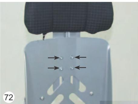
Después de aflojar los 4 tornillos puede regular la altura del reposacabezas (72).
