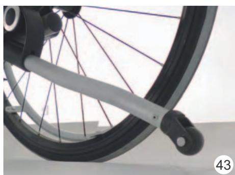
La foto 43 enseña la posición del antivuelco. Se debe ajustar a unos 2-3 cm del suelo.
