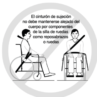
Figura 3a - Posición incorrecta del cinturón de sujeción pélvico sobre los reposabrazos de la silla de ruedas
