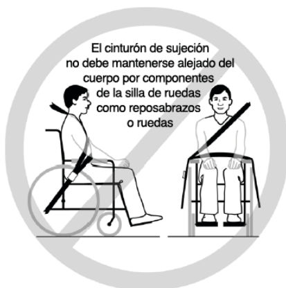
Figura 3a - Posición incorrecta del cinturón de sujeción pélvica sobre los reposabrazos de la silla de ruedas
