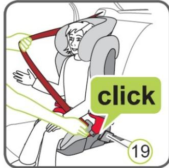
4. Coloque el cinturón diagonal (18) y el cinturón de regazo (17) en el lado de la hebilla del cinturón del asiento del automóvil (19) en la guía del cinturón rojo claro (01) del cojín del asiento.
