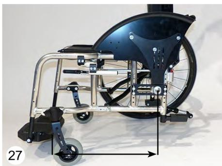
El grado activo describe la relación de la posición del respaldo con las ruedas traseras. Cuanto más posicionado esté el respaldo en la parte trasera del eje, más activo se podrá conducir el FARO. Eso significa, al contrario, una conducción más segura.
