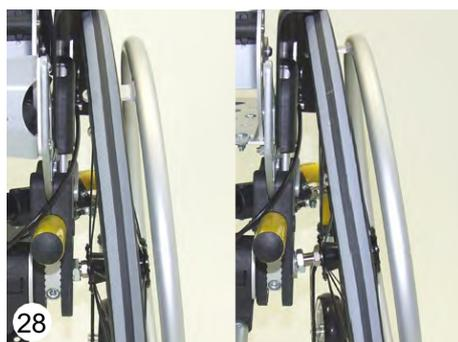
FARO está disponible con un camber (inclinación de las ruedas traseras) de 3° (28, izquierda), 6° (28, derecha) o 9° (no se muestra).
