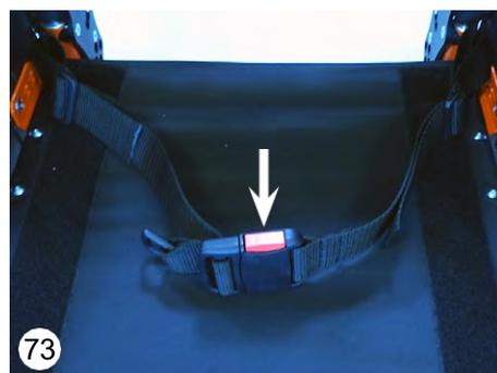
Cuando se sujeta el cinturón de regazo, se puede realizar un ajuste fino tirando de un extremo libre del cinturón (74).
