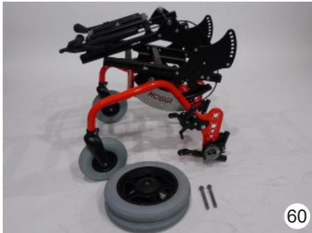
Para mayor comodidad de manipulación, puede ser preferible desmontar el sistema-silla de ruedas en algunos componentes principales.
