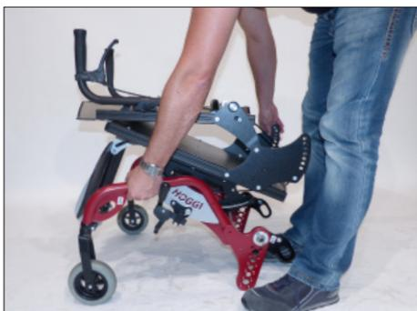
El chasis debe levantarse sólo tocando las piezas del bastidor (en el marco lateral por encima de las ruedas delanteras). Si los frenos están cerrados, también se pueden usar los empujadores para levantar.
