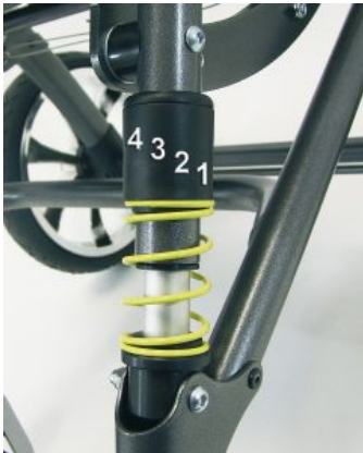
Suspensión ajustable en 4 puntos Bingo / Bingo OT
