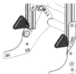
Soportes de fijación para cinturón del [chasis Sherpa](#).
