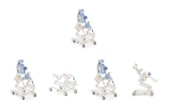
La Base Hi-Lo del <u>sistema de higiene HTS</u> es la mejor opción para aquellas personas que necesitan regular la altura del asiento mientras el usuario está encima. La altura se ajusta fácilmente y sin esfuerzo mediante un pedal ubicado a ambos lados de la Base. Fabricada en acero inoxidable, con reposapiés, ruedas dobles de 100 mm regulables en altura, basculante y disponible en las tres tallas de HTS.
