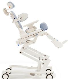
La **Base Hi-Lo** del [\*\*sistema de higiene HTS\*\*](#) es la mejor opción para aquellas personas que necesitan regular la altura del asiento mientras el usuario está encima. La altura se ajusta fácilmente y sin esfuerzo mediante un pedal ubicado a ambos lados de la Base. Fabricada en acero inoxidable, con reposapiés, ruedas dobles de 100 mm regulables en altura, basculante y disponible en las tres tallas de HTS.
